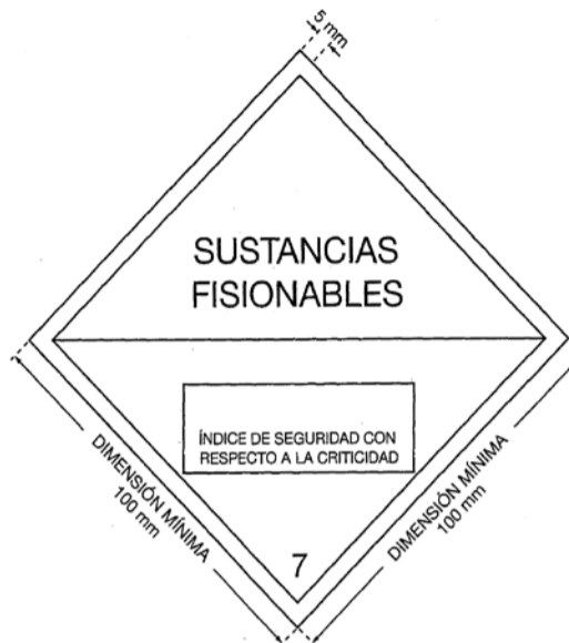
FIG. 5. Etiqueta para el ISC. El color de fondo de la etiqueta será blanco y los caracteres y líneas impresos serán negros.
