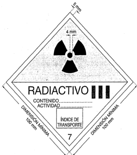
FIG. 4. Etiqueta para la categoría III-AMARILLA. El color de fondo de la mitad superior de la etiqueta será amarillo y el de la mitad inferior blanco, el trébol y los caracteres y líneas impresos serán negros y las barras que indican la categoría serán rojas.
